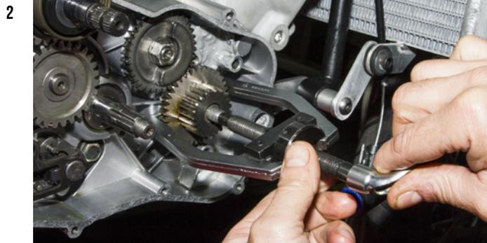
Après avoir vidangé et démonté l'embrayage d'origine, démonter le pignon du vilebrequin à l'aide d'un arrache.
