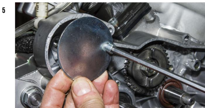
Pour éviter le reflux de l'huile de boîte, monter le cache d'origine de GPR.
