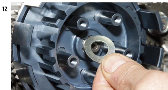
Placer ensuite la rondelle et l'écrou fournit par Bidalot et serrer au couple à 3,5mkg avec du frein filet. Verifier que la noix tourne très librement.
