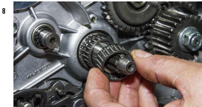
Remonter ensuite la bague et les deux douilles à aiguilles Bidalot.
