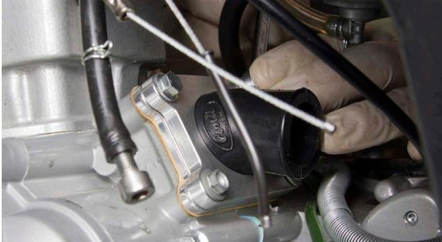
Monter l'ensemble en prenant soin de bien centrer le raccord caoutchouc avant serrage. Il reste à monter le carburateur.
