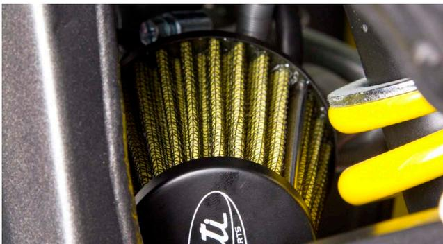
Sur ce kit admission Conti CRX, on ne peut raccorder la boîte à air d'origine. Nous préconisons un filtre à air type Conti, Malossi, Polini...
