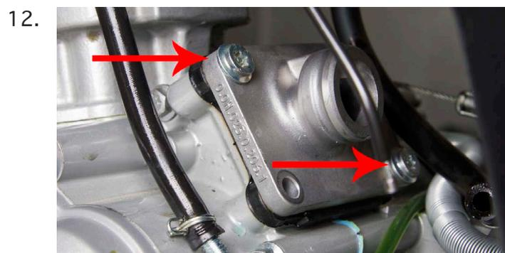
Sur les nouveaux modèles, des vis spéciales TORX sont installées.
