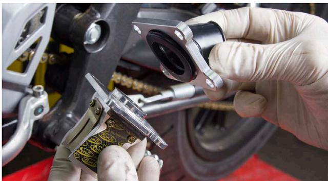
La pipe d'admission s'emboîte sur le clapet sans joint.
