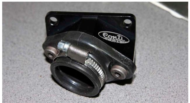
La pipe est prévue pour le montage de gros carburateurs type VHST, PWK, Koso, etc...Elle est inclinée dans le style des Honda CR.
