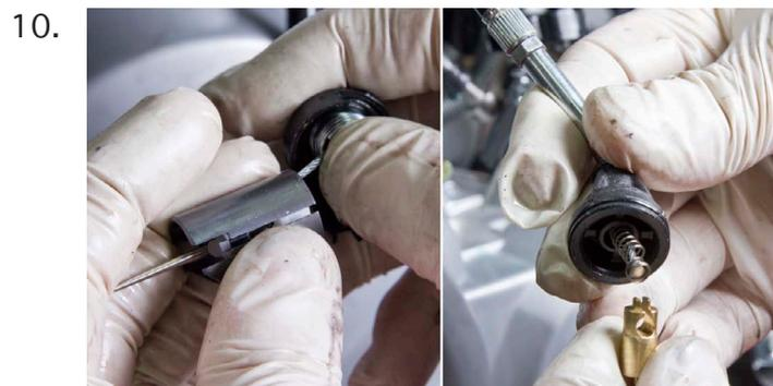
Démonter les boiseaux de starter et de gaz pour dégager les câbles.
