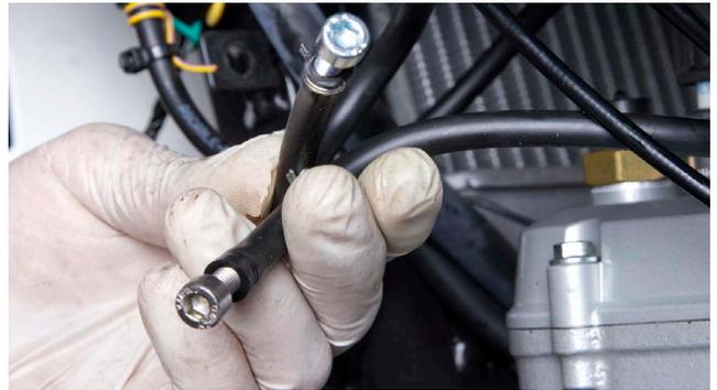
Pour les durites de réchauffeur, les boucher avec, par exemple, des vis et les attacher le long des câbles pour éviter qu'elles ne se baladent (les durites de réchauffeur sont utiles en hiver, surtout sur les carburateurs de 12 ou 17,5mm car leurs petits conduits peuvent givrer).
