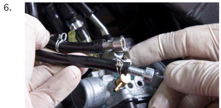
Le liquide de refroidissement va légèrement couler donc mettre, provisoirement, une vis dans chaque tuyau pour éviter de vider le circuit de refroidissement.
