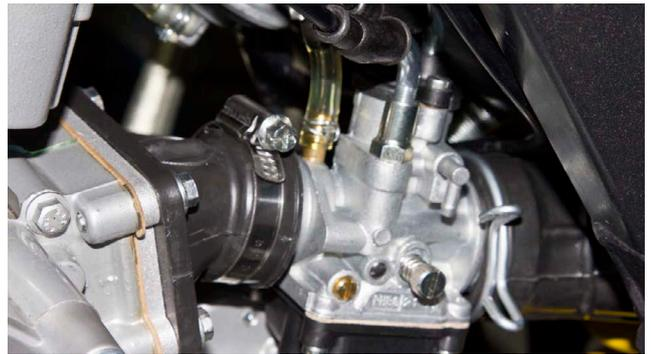
Monter l'ensemble puis refixer le carburateur comme vu dans les étapes précédentes. Vous pouvez raccorder le manchon de boîte à air d'origine ou monter un filtre à air type Conti, Malossi, Polini...
